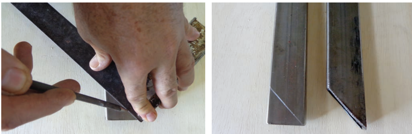
Figura 4: Marcação (A) e corte (B) da extremidade em bisel das peças para confecção da plataforma e do encosto, Embrapa Hortaliças, 2014.
